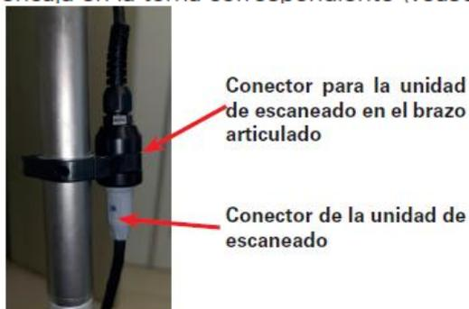
Fig.18 - Conexión de la unidad de escaneo
